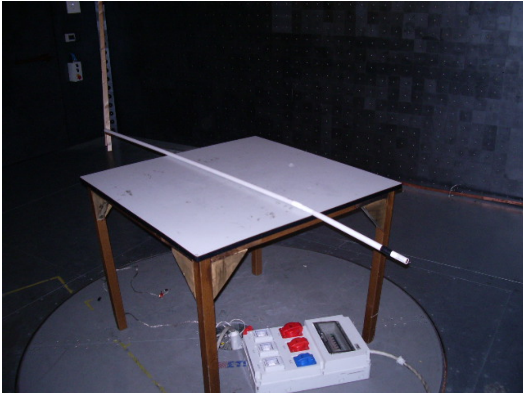
Generatore di campo di riferimento per involucri schermati tubolari
